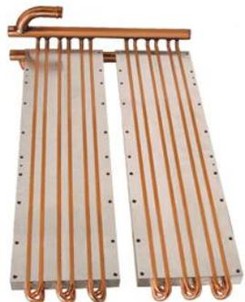
Холодные плиты активные устройства с прокачкой жидкого охладителя. Типично достижимые параметры: теплоотвод 790 Вт/см<sup>2</sup>, при увеличении температуры на 71 °С при прокачке воды со скоростью 600 мл/мин в плите с микроканалами с перепадом давления 207кПа.
